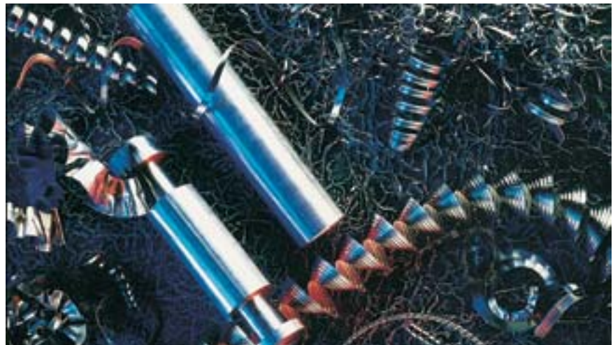
Bild 7: Beispiele von Spanausbildungen bei unterschiedlichen Schwefelgehalten
